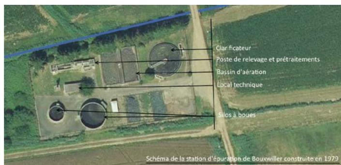
Un diagnostic de l'état du génie civil de la station d'épuration a été réalisé en octobre 2017. Celui-ci a conclu que plusieurs ouvrages étaient en état de dégradation avancée (clarificateur, bassin d'aération) ou que des travaux de remise à niveau devaient être réalisés (remplacement de l'armoire électrique, turbine d'aération, mise en place d'un traitement de l'azote...).
